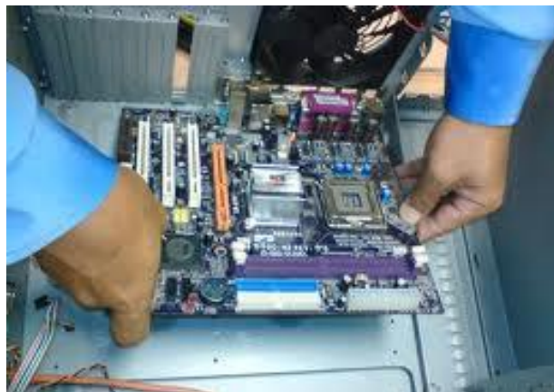
Gambar pemasangan motherboard
