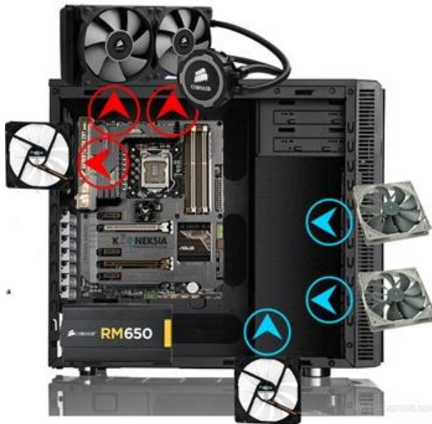
Gambar penambahan 6 fans dalam casing komputer
