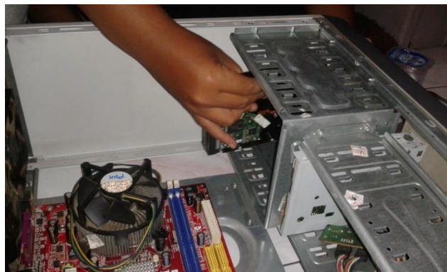
Pemasangan hard disk dalam ruang bay
