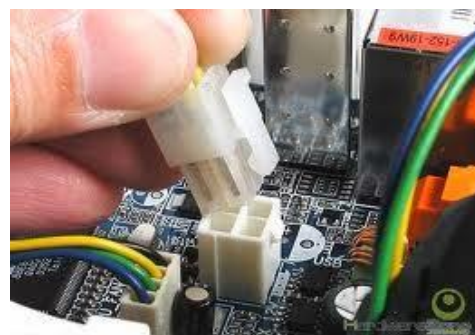
Penyambungan kabel kuasa ke motherboard
