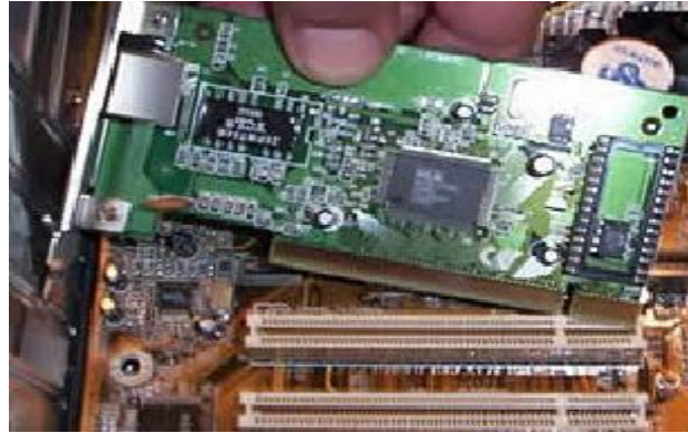
Pemasangan Kad Rangkaian
