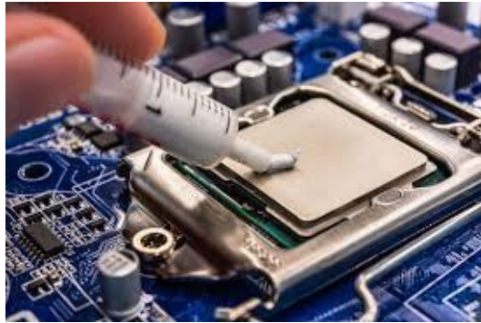
Contoh gambar meletakkan thermal paste di atas processor
