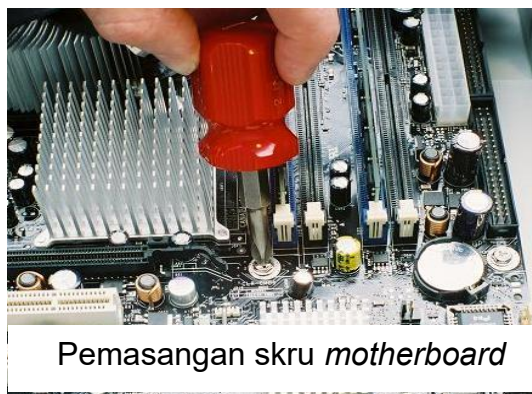
Gambar pemasangan motherboard
