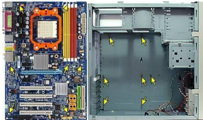
Pemasangan metal spacer / stand off dalam casing
