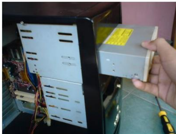
Pemasangan drive dalam casing
