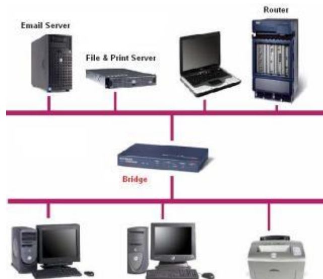
Rajah 7 : Bridge (jambatan)
