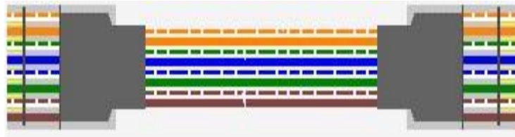
Rajah 13 : Penyambungan di kedua-dua penghujung straight cable
