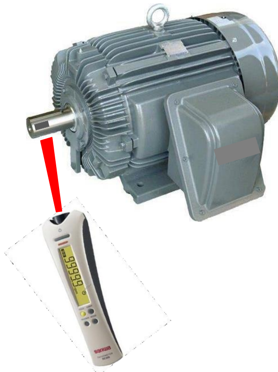
Rajah 16: Alat Uji Tachometer Dan Cara Pengujiannya
