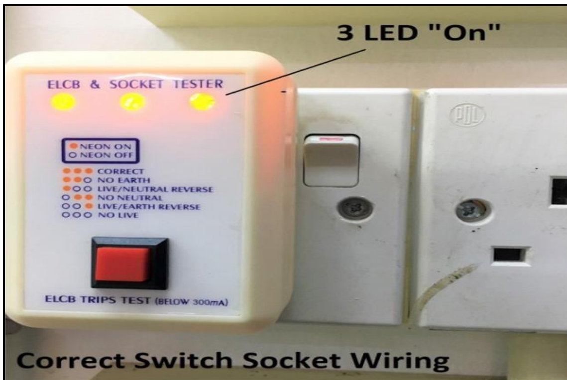
Rajah 16: Keputusan Ujian Keterusan Menggunakan Alat Penguji Socket Tester
